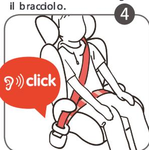
Passare la cintura attraverso le scanalature guida sotto il bracciolo, dopo inserire la linguetta di blocco della cintura di sicurezza nella fibbia, infine stringere la cintura .
