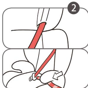
Posizionare la cintura di sicurezza attraverso la guida nel poggiatesta, posizionare la cintura di sicurezza della parte inferiore attraverso la guida sotto il bracciolo.
