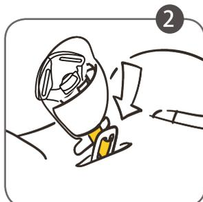
2 Inserire la placca di fissaggio nella fessura posizionata al centro della seduta e regolare la posizione della placca di fissaggio.
