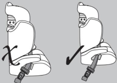
**REMARQUE :** L'installation achevée, la boucle de la ceinture de sécurité de la voiture ne doit pas se trouver à l'intérieur du passant, mais comme illustré sur la figure.
