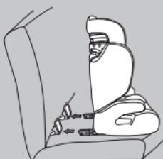
Positionner le siège auto face à la route , sur le siège passager.
