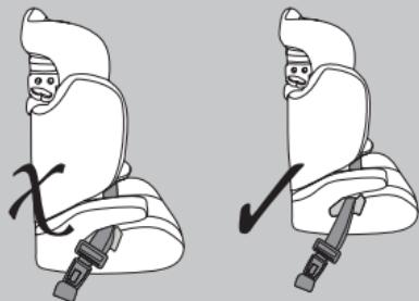
**NOTA:** Cuando finalice la instalación, la hebilla del cinturón de seguridad del vehículo no debe estar dentro de la guía, sino como se muestra en la figura.
