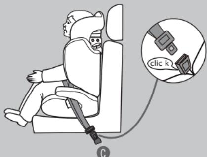
Faire passer la ceinture de sécurité sur l'enfant et enfiler le connecteur de la boucle dans le passant ceinture (B) sur le côté à proximité de la boucle d'accrochage de la ceinture (C).
