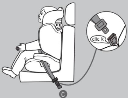
Después de haber enganchado el cinturón de seguridad a la hebilla (C), tense el cinturón tirando primero del cinturón abdominal y después del cinturón pectoral, para eliminar la holgura del cinturón.
