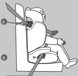
Collocare il bambino nel seggiolino e regolare l'altezza e la forma del sedile in base alla corporatura del bambino, (vedere punto precedente). Assicurare il bambino utilizzando la cintura a 3 punti, in dotazione al veicolo, facendo passare la cintura pettorale del veicolo attraverso il passante guida cintura (A) e la cintura addominale del veicolo attraverso il passante cintura (B).
