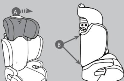
Il rivestimento ha un impatto diretto sul funzionamento del dispositivo di ritenuta in termini di sicurezza. Non utilizzare mai il seggiolino auto privo del rivestimento.
