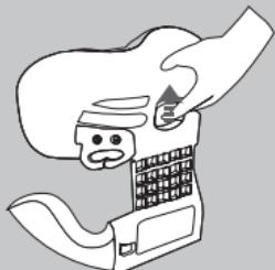
Pour régler la hauteur et la largeur du siège auto, appuyer sur le levier de réglage derrière l'appuie-tête et soulever l'appuie-tête vers le haut ou vers le bas pour obtenir la hauteur et la largeur souhaitée. Relâcher le levier et s'assurer que l'appuie-tête soit bloqué dans la nouvelle position.
