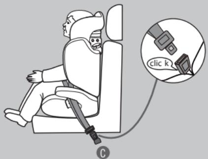
Per garantire una migliore protezione al bambino, la cintura di sicurezza pettorale del veicolo deve passare nel passante guida cinture superiore in prossimità
