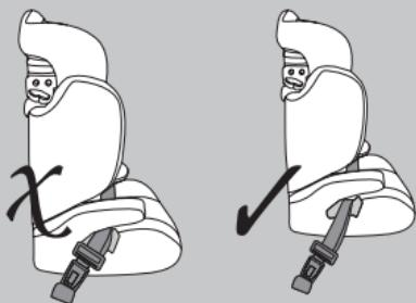
**NOTA:** A installazione completa la fibbia della cintura di sicurezza dell'auto non deve risultare all'interno del passante, ma come mostrato in figura.
