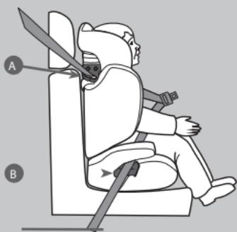
Installer l'enfant dans le siège auto et régler la hauteur et la forme du siège en fonction de la taille de l'enfant, (voir le point précédent). Attacher l'enfant en utilisant la ceinture à 3 points, dont est dotée le véhicule, en faisant passer la ceinture pectorale du véhicule à travers le passant de guidage de la ceinture (A) et la ceinture abdominale du véhicule à travers le passant ceinture (B).
