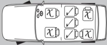
La sillita se puede usar solo con cinturones de seguridad de 3 puntos (A) con enganche ISOFIX y NO con cinturones de seguridad de 2 puntos (B).
