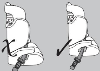
**ΣΗΜΕΙΩΣΗ:** Όταν ολοκληρωθεί η εγκατάσταση η πόρπη της ζώνης ασφαλείας του αυτοκινήτου δεν θα πρέπει να είναι μέσα στο βρόχο αλλά όπως υποδεικνύεται στην εικόνα.
