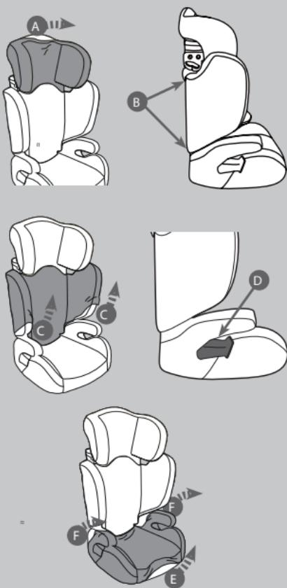
O revestimento tem um impacto direto no funcionamento do dispositivo de retenção em termos de segurança. Nunca utilizar a cadeira para automóvel sem revestimento.
