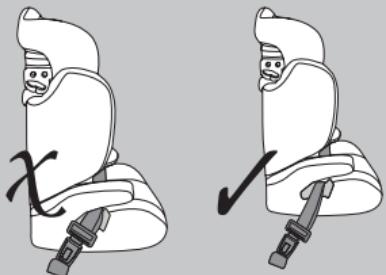
**NOTA:** No final da instalação, a fivela de segurança do automóvel não deve estar no interior do passante mas como ilustrado na figura.
