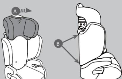
Le revêtement a un impact direct sur le fonctionnement du dispositif de retenue du point de vue de la sécurité. Ne jamais utiliser le siège auto sans le revêtement.
