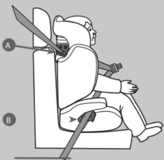
Acomode al niño en la sillita y regule la altura y la forma del asiento en base a la complexión del niño (véase el punto anterior). Asegure al niño utilizando el cinturón de 3 puntos del vehículo, pasando el cinturón pectoral del vehículo por la guía del cinturón (A) y el cinturón abdominal del vehículo por la guía del cinturón (B).
