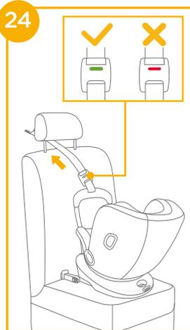
! Se l'angolo di inclinazione è regolato, controllare la tensione sull'imbracatura superiore o allentare per regolare l'angolazione, quindi ritensionare.
