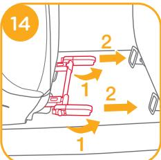
3. Alinhe os conectores ISOFIX com os pontos de fixação ISOFIX e, em seguida, encaixe ambos os conectores ISOFIX nos guias ISOFIX. **15**
