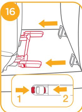
b. Drehen Sie die ISOFIX-Befestigungen um 180 Grad, drücken Sie dann den ISOFIX-Einstellknopf, um die ISOFIX-Befestigungen zusammenzuklappen. **17**
