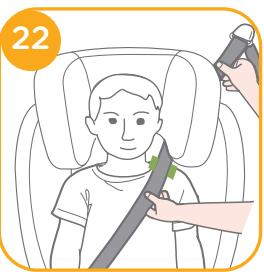
! Assicurarsi che la parte della cintura per le spalle del veicolo passi direttamente attraverso la relativa guida come mostrato in **23**
