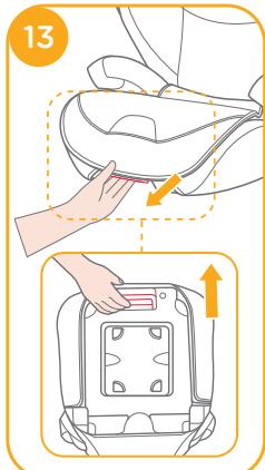
Faites tourner les connecteurs ISOFIX à 180 degrés jusqu'à ce qu'ils pointent dans la direction des guides ISOFIX. **14**
