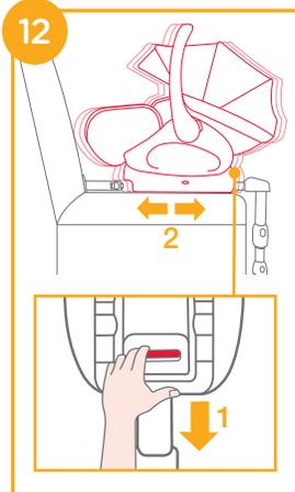
8. Per rilasciare il modulo culla portatile, sollevarlo **13** -2 mentre si preme il pulsante di regolazione del modulo culla portatile. **13** -1
