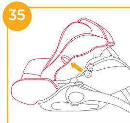
4. Infilare la cintura per le spalle attraverso la relativa fessura. <sup>36</sup>
