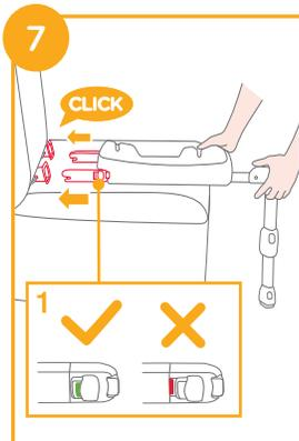
4. Dopo aver posizionato la base sul sedile del veicolo, estendere il supporto per aprirlo sul pianale **8**. Se l'indicatore del supporto è verde significa che è installato correttamente; se è rosso significa che è installato in modo non corretto. **8** -3
