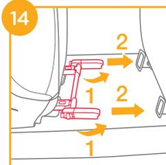
3. Alinee los conectores ISOFIX con los puntos de anclaje ISOFIX y, a continuación, introduzca ambos conectores ISOFIX en las guías ISOFIX hasta que escuche un clic. <sup>15</sup>
