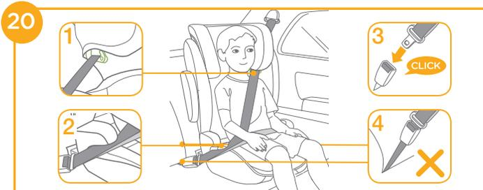
! Também pode ser instalado usando apenas um cinto de segurança de 3 pontos de fixação. (ver imagens <sup>20</sup> - <sup>24</sup>)
