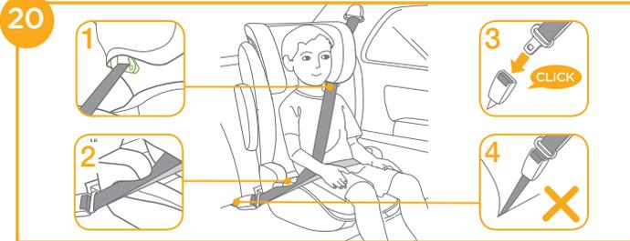
! Kann auch ausschließlich mittels 3-Punkt-Gurt installiert werden. (siehe Abbildungen <sup>20</sup> - <sup>24</sup>)
