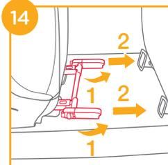
3. Richten Sie die ISOFIX-Befestigungen mit den ISOFIX-Verankerungspunkten aus und rasten Sie beide ISOFIX-Befestigungen in den ISOFIX-Führungen ein. <sup>15</sup>
