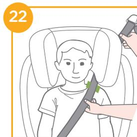
! Ramenní část bezpečnostního pásu vozu musí procházet přímo vodičím otvorem ramenního pásu jako na obrázku v 23
