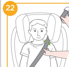
! Assicurarsi che la parte della cintura per le spalle del veicolo passi direttamente attraverso la relativa guida come mostrato in
