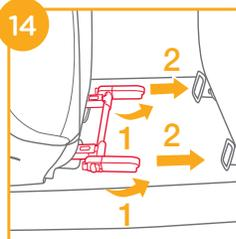
3. Alignez les connecteurs ISOFIX avec les points d'attaches ISOFIX, puis insérez les deux connecteurs ISOFIX dans les guides ISOFIX. <sup>15</sup>
