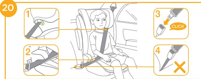
! Yalnızca 3 noktalı kemer kullanılarak da kurulabilir. (bkz. şekil <sup>20</sup> - <sup>24</sup>)
