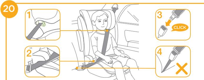
! Può essere installato anche utilizzando solo la cintura a 3 punti di cui sopra. (vedere le figure <sup>20</sup> - 24)
