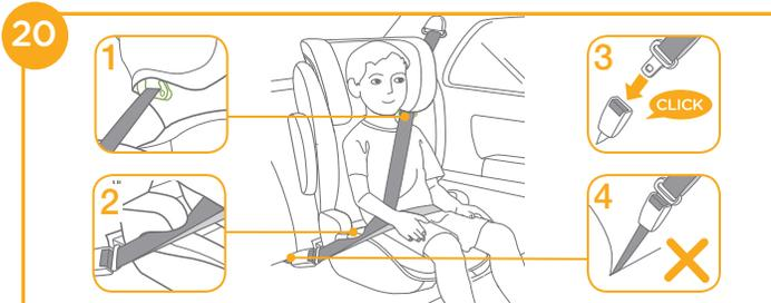
! Lze rovněž nainstalovat pouze s použitím 3bodového bezpečnostního pásu. (viz obrázky <sup>20</sup> - <sup>24</sup>)
